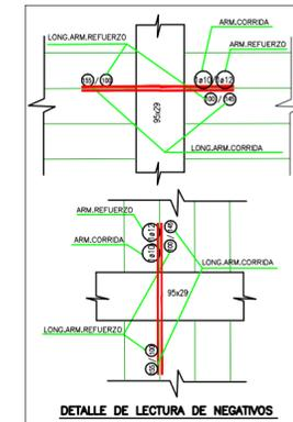
SECCION TIPO FORJADO UNIDIRECCIONAL
